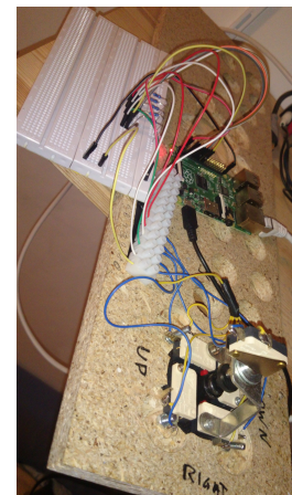
Abbildung 2: Der alte Schaltungsprototyp für Buttons & Joysticks (gelötet) - jetzt bereits eingebaut
